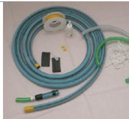
Система гидроизоляции холодных и конструктивных швов в сооружениях, подверженных постоянному или периодическому напору воды. Представляет собой реинъекционный шланг, закладываемый на стадии бетонирования в шов, к которому вследствие при протечке подсоединяется инъекционный насос с гидроизоляционным составом. Многократное использование!
